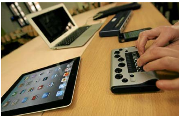
Ce mini-clavier traduit en Braille les informations affichées par cette tablette numérique.
